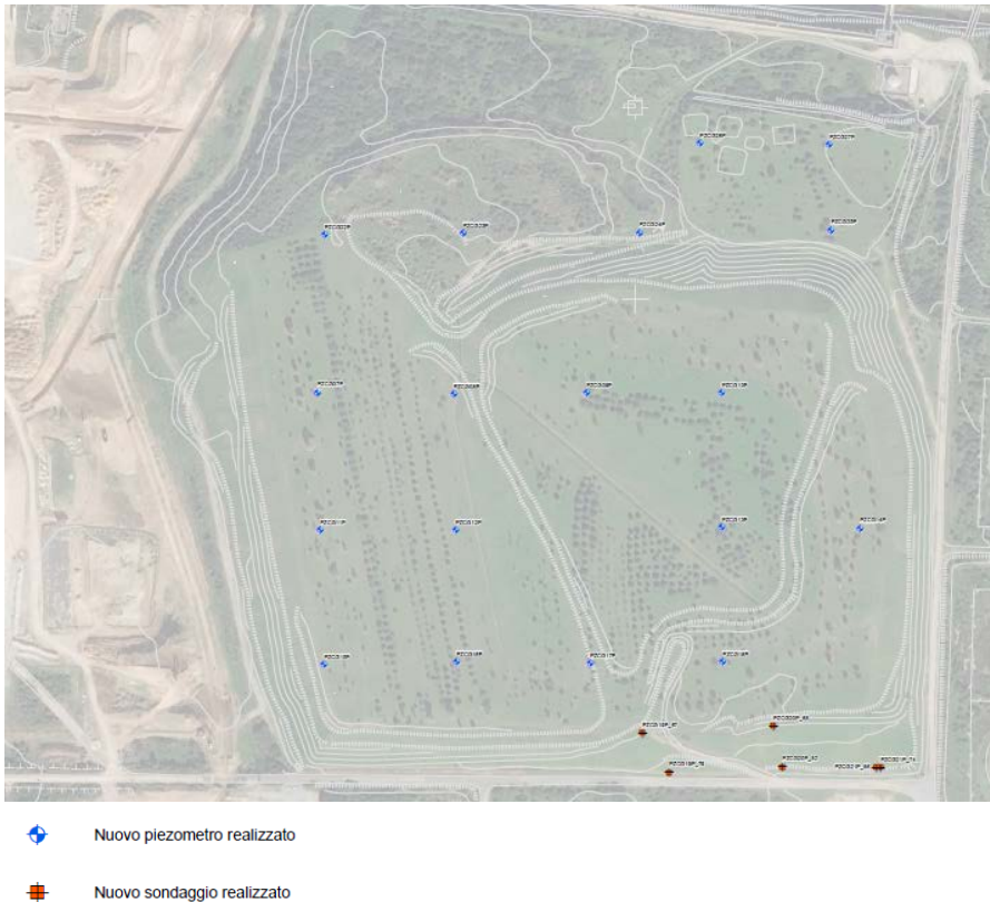
Figura 11: Area Cava Gessi – Stato avanzamento indagini al 30 settembre 2021
